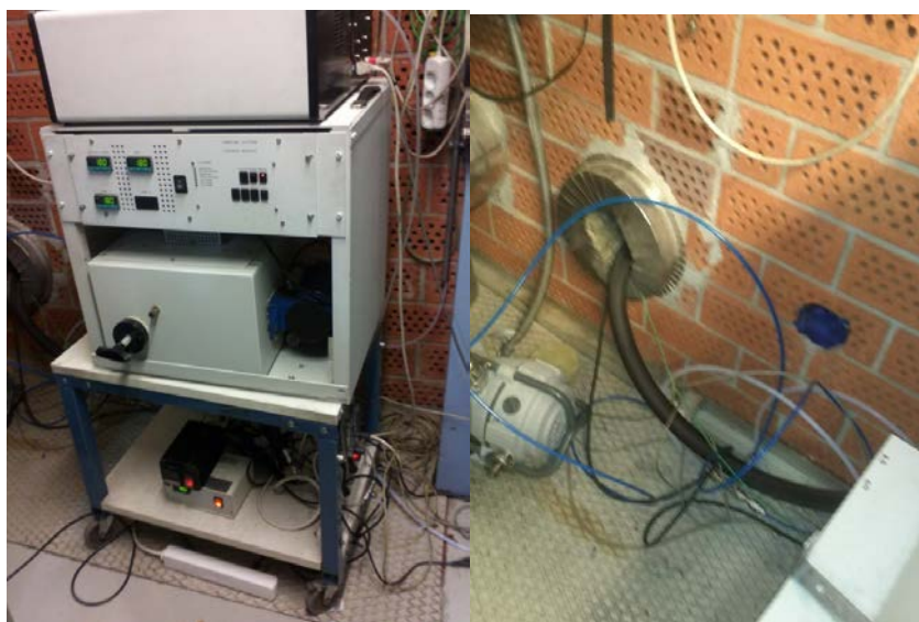
Figur 2.5: Registrering av avgassenes absorpsjon av infrarødt lys og med FTIR instrumentering ved VTT.
