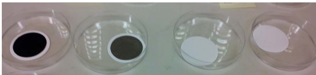
Figur 3.4: To filtre med oppsamlede utslipp av PM (avgasspartikler) fra en avgasstest med en personbil med direkte innsprøyting (DI teknologi) av bensin til venstre og to filtre med tilsvarende utslipp av PM, avgasspartikler fra en Euro 6 personbil med dieselmotor til høyre.
