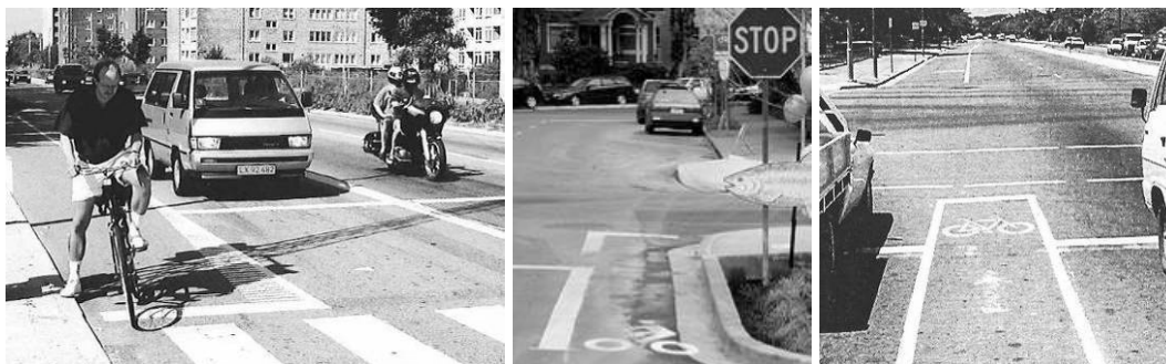
Figur 88. Eksempler på tilbaketrukket stopplinje for biler i Danmark, USA og Australia (Vejdirektoratet 200b, BikePortland 2008, Austroads 1999).
