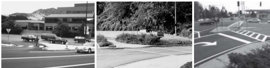
Figur 108. Eksempel på trafikkøy og oppmerket gangfelt i kryss med kileformet eller parallellført høyresvingfelt i USA (Oregon Department of Transportation 1995, Washington State 1997, Vermont Agency of Transportation 2002).
