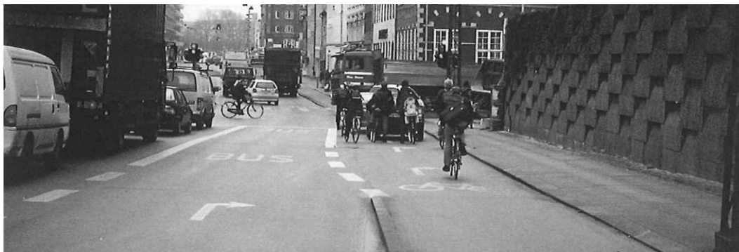
Figur 119. Kort kollektivfelt før kryss (Vejdirektoratet 2003a).
