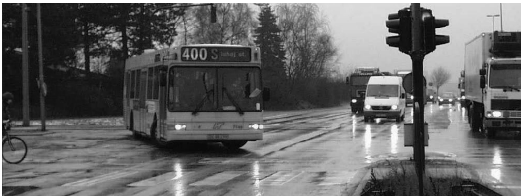
Figur 121. Eksempel på venstresving av buss fra høyre vegside i dansk signalregulert kryss (Vejdirektoratet 2003a).
