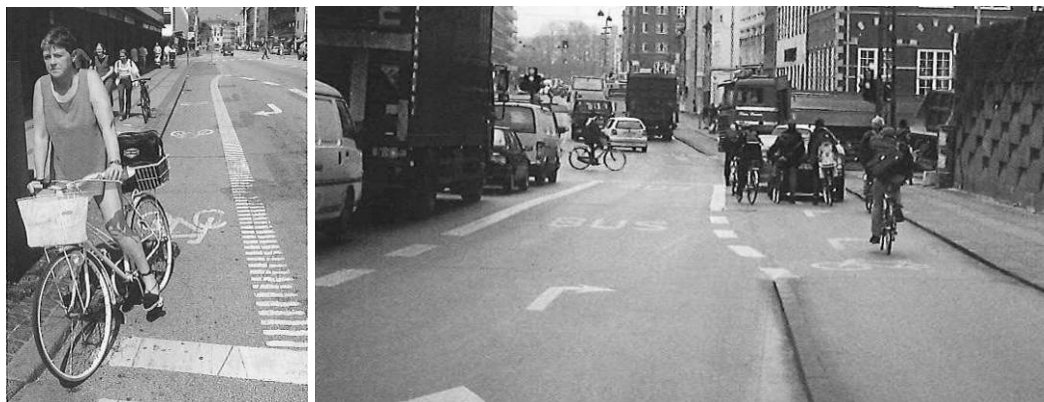
Figur 66. Eksempler på avkortet sykkelveg i Danmark, hvor sykkelveg er blitt erstattet med henholdsvis sykkelfelt og blandet trafikk (Vejdirektoratet 2000b).
