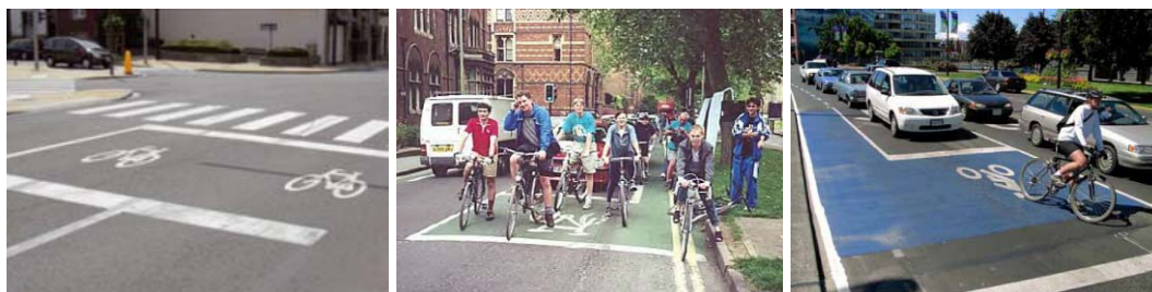
Figur 84. Eksempler på sykkelboks i Belgia, England og Canada (BIVV 2007, Greenways 2008, Drdul 2004).
