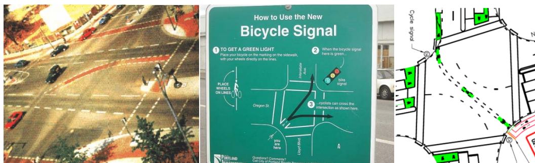
Figur 3. Eksempler på separat venstresvingfelt for sykler i kryss i Tyskland og USA (Sachsen Anhalt 2003, Kloos, 2005, Milke, Hinton og Newcombe, 2007).
