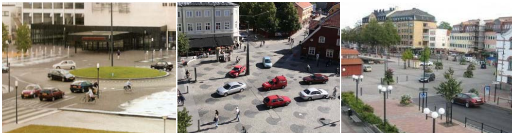
Figur 45. Kryss utformet som shared space i Drachten i Nederland og i Norrköping og Västervik i Sverige (Tyrens 2007).
