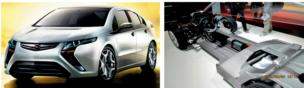
Figur 3.3: Opel Ampera har batterier som lades via nettet eller med bensinmotor
