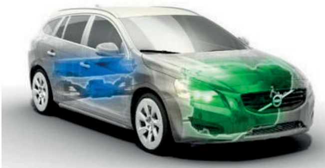
Figur 3.4: VolvoV60 ladbar hybrid er en dieselbil frem og en elbil bak
