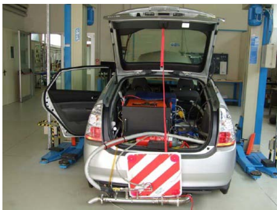
Figur 5.12: Avgassmålinger med måleutstyr i bil. Kilde: Weiss 2011
