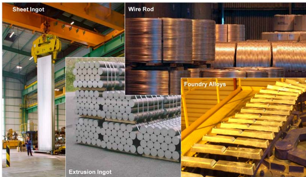
Figur 7.2. Valseblokk ("Sheet ingot"), pressbolt, ("Extrusion Ingot"), aluminiumstråd ("Wire Rod") og støpelegeringer ("Foundry Alloys") som leveres fra smelteverkene.
