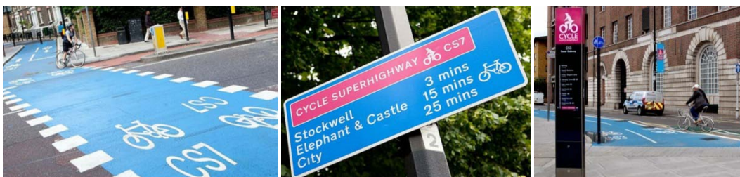
Figur 42. Oppmerking og skilting av rute med unikt rutenummer, skilting av reisetider samt informasjonstavler om reiseruten (TfL, 2012).
