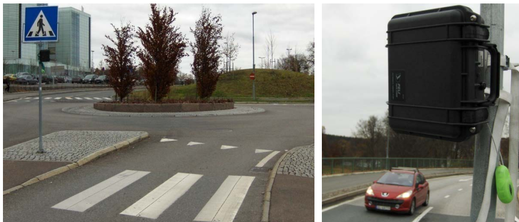
Figur 4. ICONS TMS-SA mobil radarmåler (Foto: M. Sørensen).
