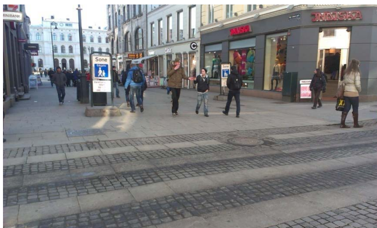
Figur 9: Taktile varselfelt skal brukes til varsling av fare, spesielt ved fotgjengerfelt, trapper og kanter. Dette gjennomføres ikke alltid, som for eksempel her hvor gågaten Karl Johans gate i Oslo krysser trafikkert gate med lysregulering (foto: Aud Tennøy).
