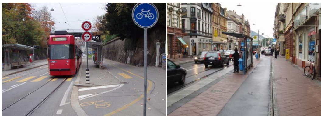
Figur 47. Holdeplass for trikk i Bern der sykkelveg er til høyre for holdeplass (Pfeiffer 2013).
