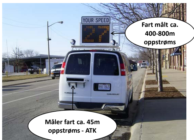
Figur 5.15: Fartsmålingstavle med automatisk fartskontroll i vegarbeidsområde (Benkøhal et al., 2010).
