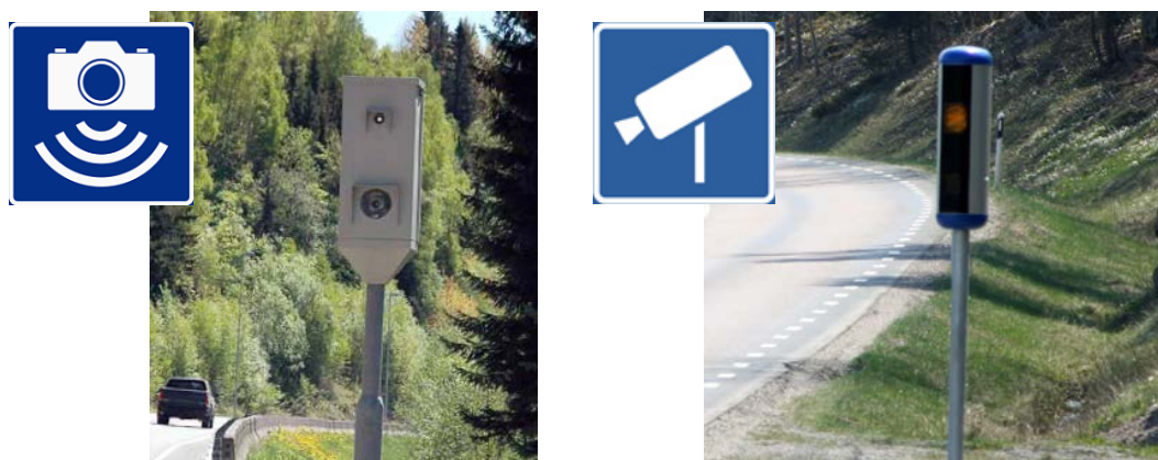
Figur 5.11: Punkt-ATK; kamera (fotoboks) og skilt for forhåndsvarsling i Norge (t.v.) og Sverige (t.h.). Kilde. Statens vegvesen, 2011; Trafikverket.
