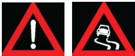
Figur 5.6: Fareskilt for trafikal hendelse (benyttes for tåkevarsling) og unormalt glatt veg (Statens vegvesen).
