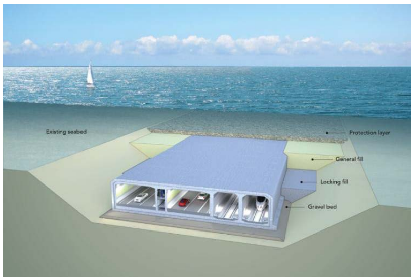
Figur 6.12: Senketunnel bygget av moduler.
