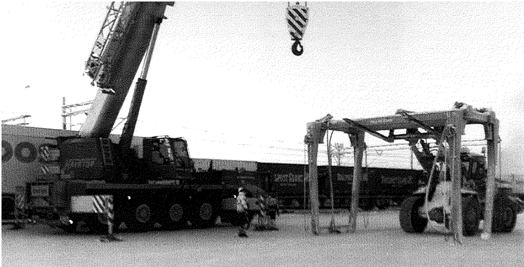
Figur 6.3. Illustrasjon av «åke» som kan benyttes til løfting av semitrailer på tog. Kilde: CargoNet.
