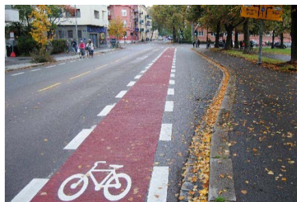
Figur 16. Midtstilt sykkelfelt i et kryss i Oslo (Foto: M. Sørensen).
