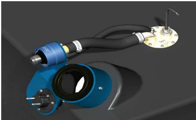
Fig 7: Et bunnfyllingssystem, AT-1, med integrert utlufting for rask tanking av ED95 ble montert i alle ED95 kjøretøy for å oppnå akseptabel fyllehastighet på 80-100 l/min.
