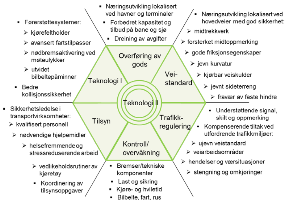
Figur 6.1: Forbedringspotensial på seks områder for reduksjon av alvorlige ulykker med bruk av tunge kjøretøy.
