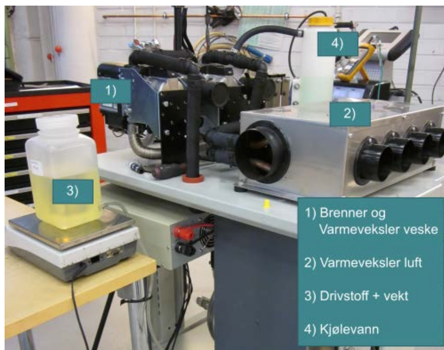
Figur 38: Oppsett av tilleggsvarmeren. Testene ble utført ved romtemperatur ved kald- og varmstart av varmeren.
