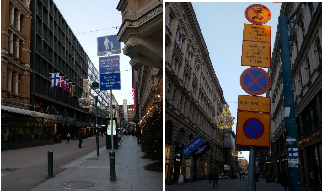
Figur 13: Gågateskilting, med underskilt som sikrer varelevering og tilgang for taxi. Foto: Oddrun Helen Hagen.
