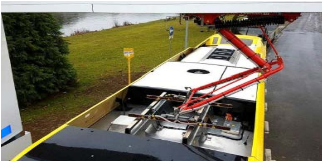
Figur 3.4: Nedsenkbar pantograf hvor den rørlige delen på selve ladeordningen senkes ned for å få kontakt med skinnene på bussens tak (Bilde: Internett).
