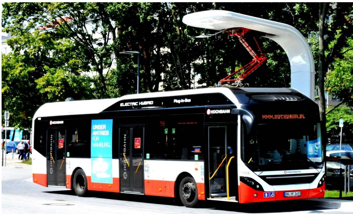
Figur 3.3: Hurtiglading av elbusser med en pantograf som i dette tilfelle senkes ned og på taket tilkobles bussens elektriske system (Bilde: Internett).
