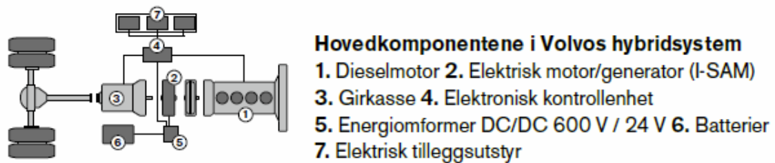
Figur 6.2: Volvos design for parallell hybrid fremdrift av buss. (Bilde: Volvo).
