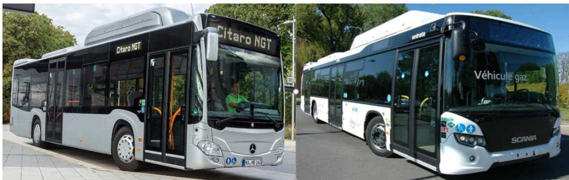
Figur 5.5: Gassbusser med Euro VI-motorer og meget lave utslipp av lokalt helseskadelige avgasser. (Bilder: Mercedes og Scania)
