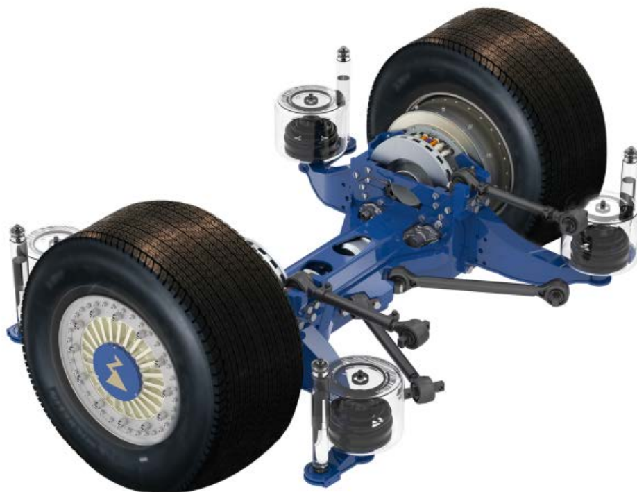
Figur 3.5: Bakaksel til elbuss med elmotorer integrert i hjulene (Bildet: Hybricon AB).
