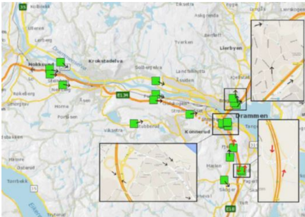
Figur 5.3. Utforming av enveis bomsystem i Buskerudbyen
