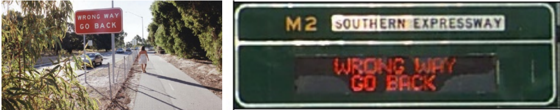
Figur 55. Statisk og dynamisk ”Indkørsel forbudt” skiltning (Cooner, Cothron og Ranft, 2004a).
