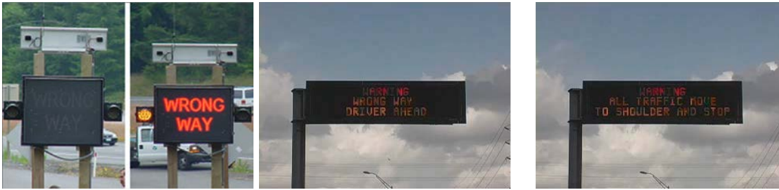
Figur 51. Advarsel via skilte til spøgelsesbilister om, at de kører forkert vej og advarsel til andre bilister om, at en spøgelsesbilist er på vej mod dem (Zhou og Pour-Rouholamin, 2014).
