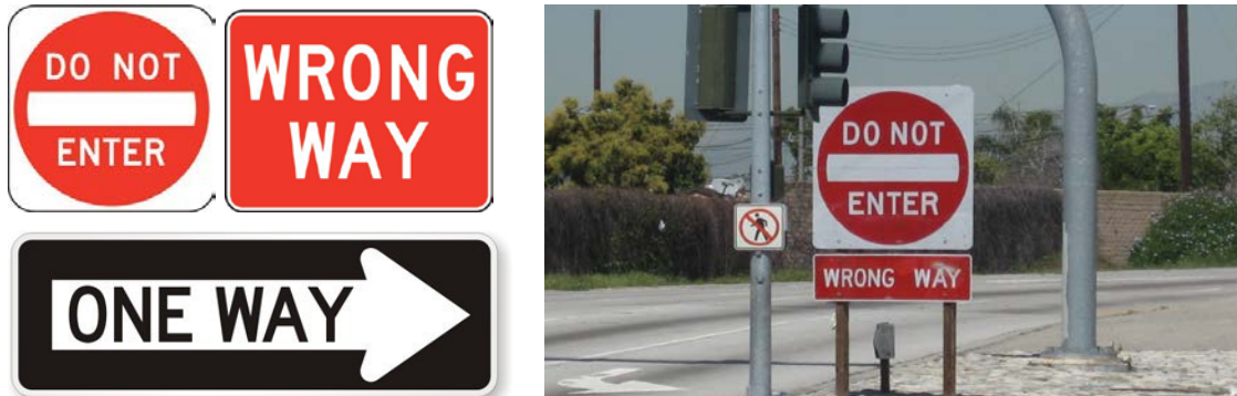
Figur 36. Minimum skiltning med tre skilte på frakørselsramper (NTSB, 2012), og et eksempel fra Californien på en kombineret skiltning med "Do Not Enter" og "Wrong Way" (Zhou m.fl., 2012).
