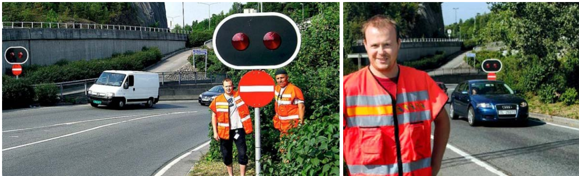
Figur 19. Stopblinksignal i Vækerø-krydset i Oslo i 2006 (Lund, 2006; Baumberger, 2006).
