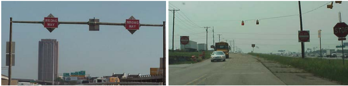
Figur 42. Overhængt "Wrong Way" skilte og blinkende lys (Cooner, Cothron og Ranft, 2004a).
