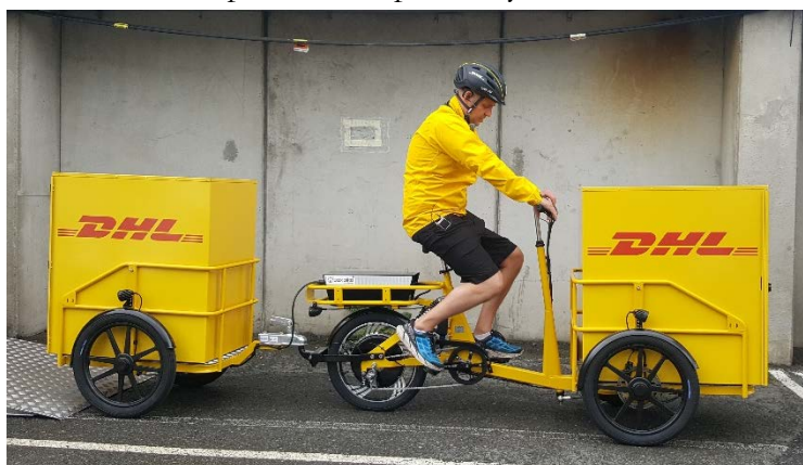
Figur 12: Den elektriske lastesykkelen som DHL Express benytter i sine leveranser. Batteriet er plassert bak på lastesykkelen.
