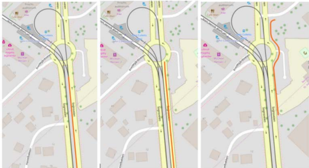
Figur 3.2: Eksempel på utsnitt fra OSM-nettverket ved John-Collets plass. Til venstre er trikke-traseen markert som en egen lenke, i midten er et kjørefelt markert som en egen lenke (med informasjon om sykkelfelt) og til høyre er gangfeltet en egen lenke. I alle tre eksemplene er den omtalte lenken markert i rødt.
