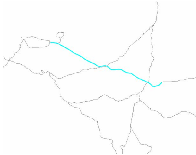
Figur 3.3: Eksempel på uheldig oppsplitting av veilenke i OSM. Den markerte lenken (i lyseblått) krysser to andre veier uten at man har mulighet til å svinge av.
