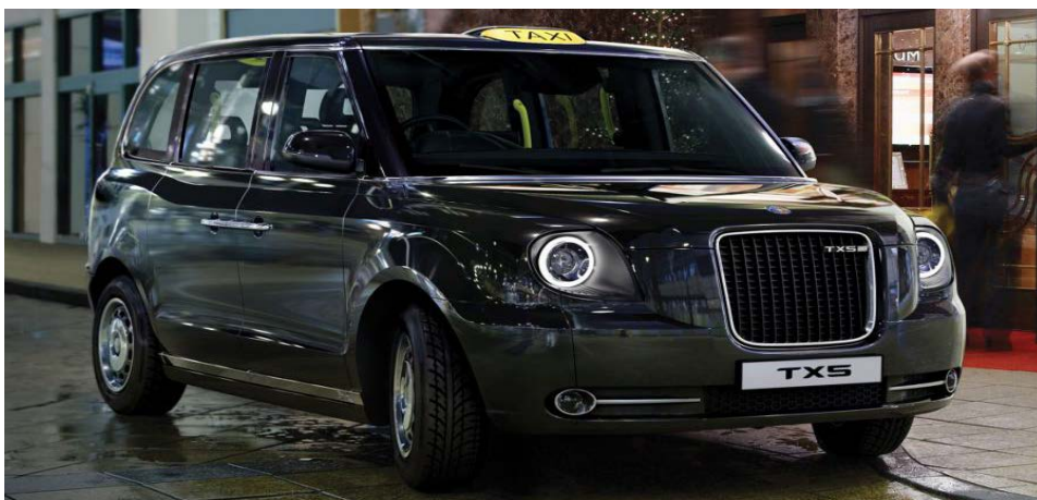
Figur 4.12: Elbiler med rekkeviddeforlenger som Londondrosjen LEVC TX er et mulig alternativ for drosjer med behov for ubegrenset rekkevidde dersom alternativene med nullutslippsbiler ikke skulle oppfylle forventningene frem mot 2025.
