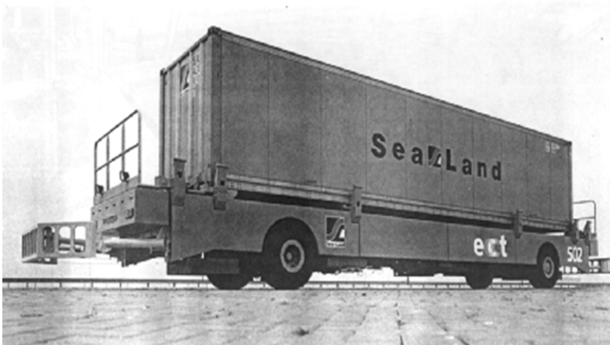
Figur 2-2 Eksempel på en automatisert forflytning av containere på en større terminal
