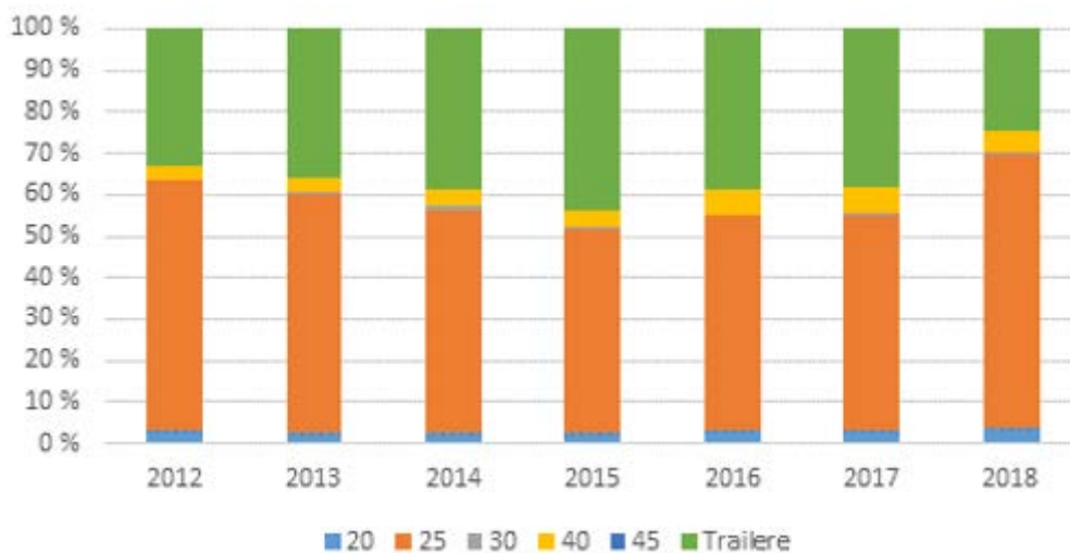
Figur 3-6 Fordeling av lastbærere på ulike lengdedimensjoner i fot i CargoNets produksjon, 2012-2018. Kilde: CargoNet.
