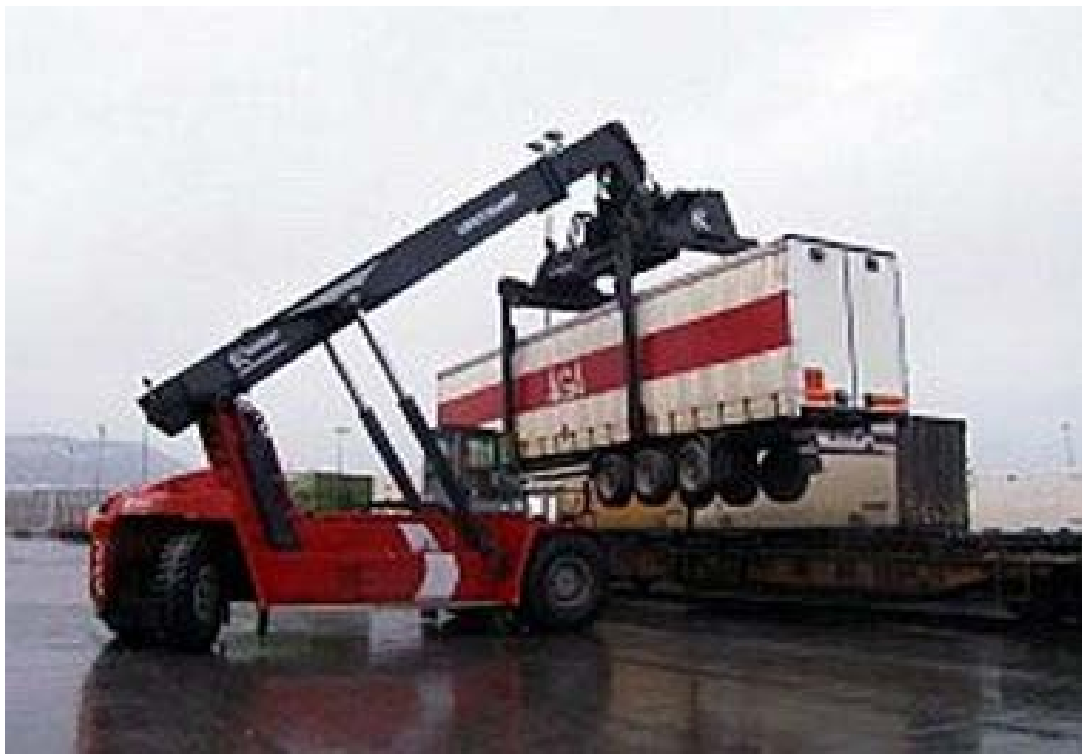
Figur 2-6 Eksempel på intermodal transport basert på semitrailer
