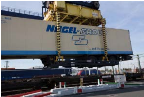
Figur 4-3 Løfting av semitrailer i vugge.
