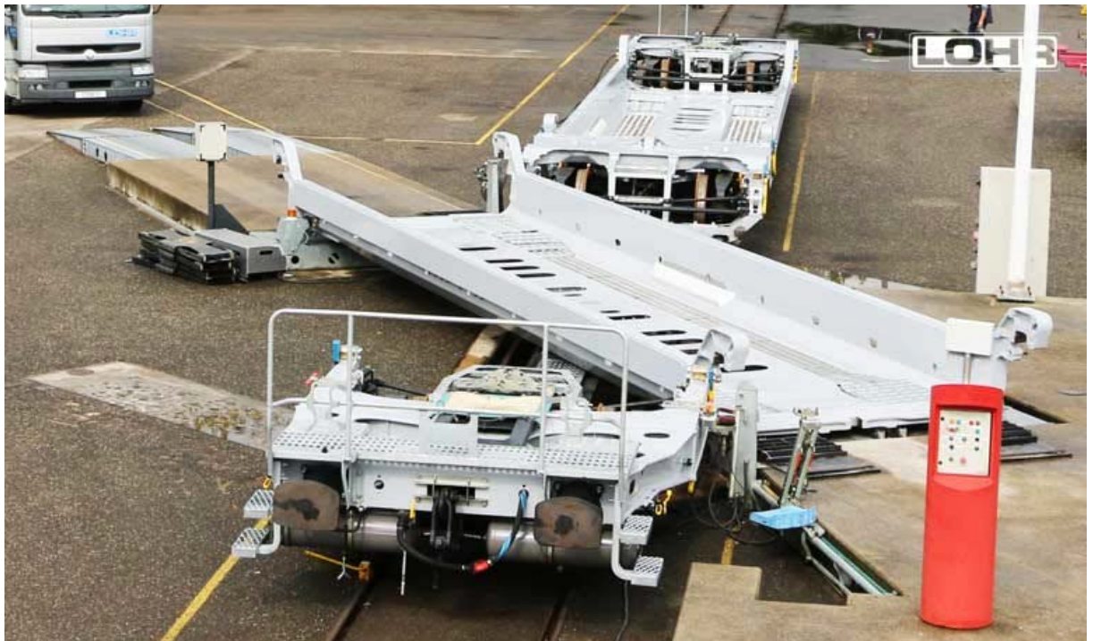
Figur 4-1 Eksempel på løsning med omlasting av semitrailere basert på hydraulikk i vogner. (Kilde: LOHR, 2018)
