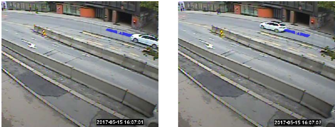
Figur 5: Sensoren registrerer varigheten når et objekt passerer området
