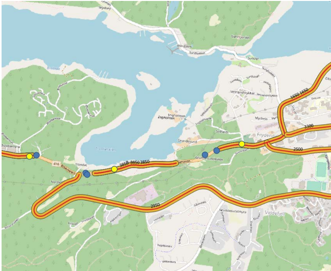
Figur 4. Veglenker som mangler ÅDT og der tilstøtende holdeplass ikke får opplysninger. Trafikkmengde indikeres med rødt, holdeplasser med ÅDT er markert gul og holdeplasser uten opplysninger er blå.
