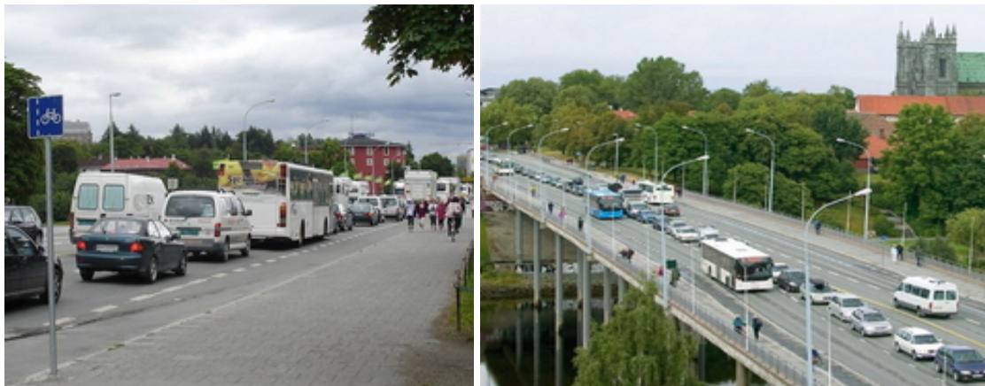
Figur 9: I 2008 ble ett felt i hver retning i Elgsetergate i Trondheim gjort om fra bil- til kollektivfelt. Foto til venstre viser forsituasjonen, der bussene står i kø sammen med bilene. Foto til høyre viser ettersituasjonen, hvor busstrafikken har fått økt fremkommelighet. Foto: Steinar Simonsen.
