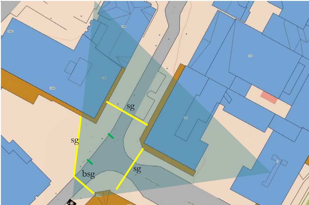
Figur 3: Krysset Storgata/Jernbanegata i Porsgrunn, hvor det ble gjennomført intervjuer og videoregistrering. Prinsippskisse av kameraplassering med bildevinkel, tellesnitt og oppmerking for fartsmåling. Gule linjer angir tellesnitt for syklister (s), bilister
