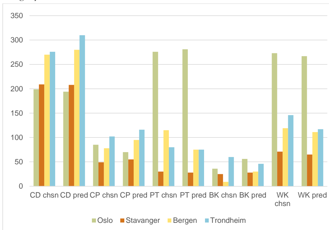
Figur 3.30: Observert og predikert transportmiddelfordeling i de fire største byene.
