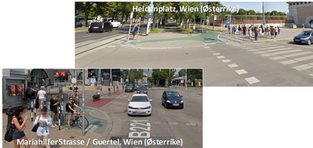
Figur 18: Flerfarget dekke med ulike farger på strekninger / krysninger med bilveg og i konfliktområder sykkel-fotgjenger.
