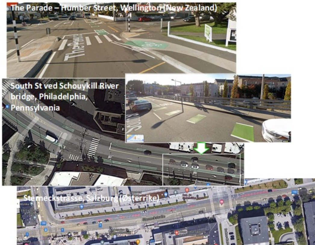
Figur 16: Bredstripet grønt dekke i kryss og konfliktområde i New Zealand (bilde tatt mot kjøreretningen) og USA.
