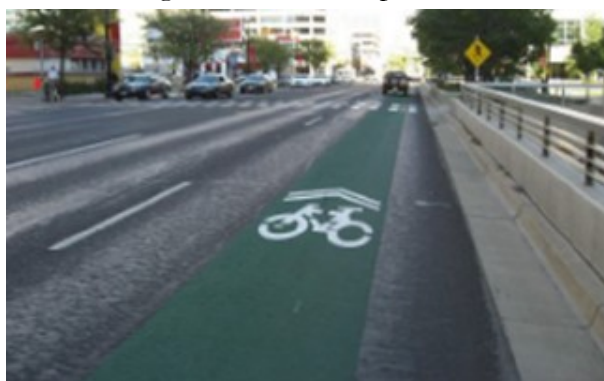
Figur 24: Sharrows med farget bakgrunn («lane-within-a-lane») i Salt Lake City (Furth & Dulaski, 2010).
