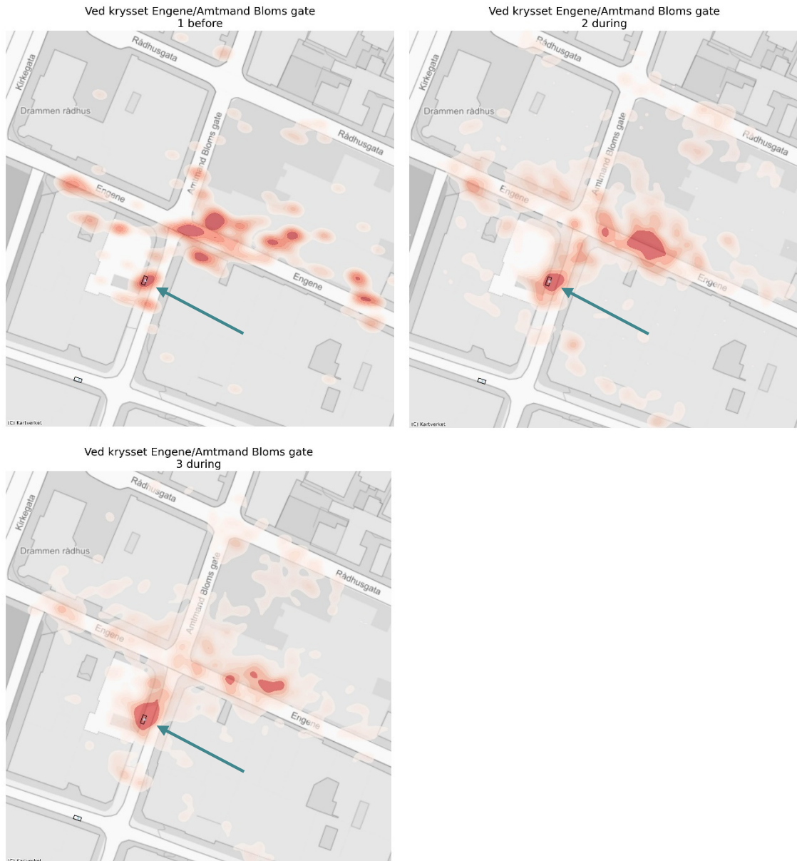
Figur 5.13: Varmekart over tetthet i parkerte elsparkesykler rundt parkeringsplassen ved krysset Engene/ Amtmand Bloms gate. Kartbakgrunn fra Kartverket.
