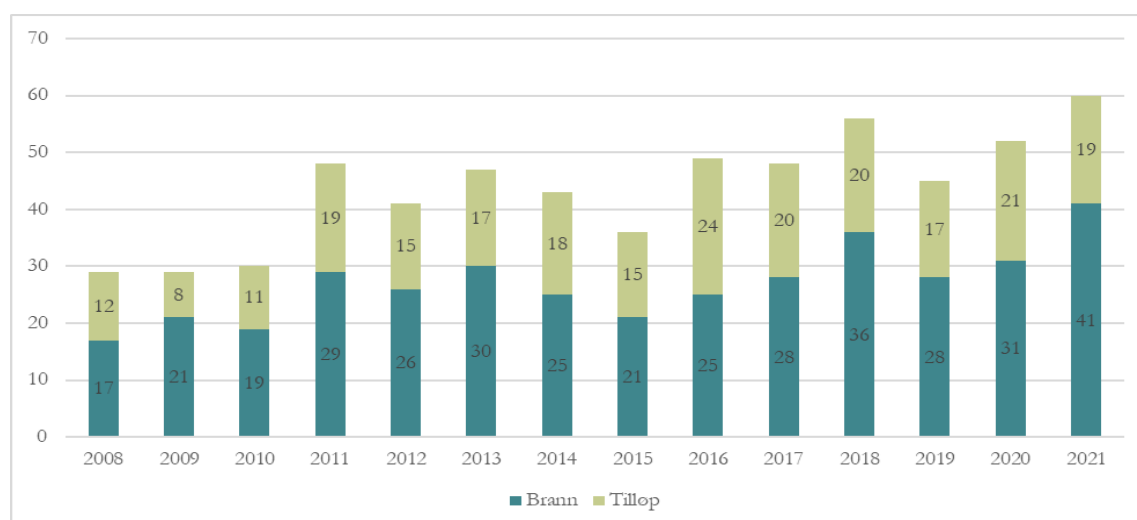
Figur S.1: Branner og tilløp i norske vegtunneler i perioden 2008-2021 (N=613).
