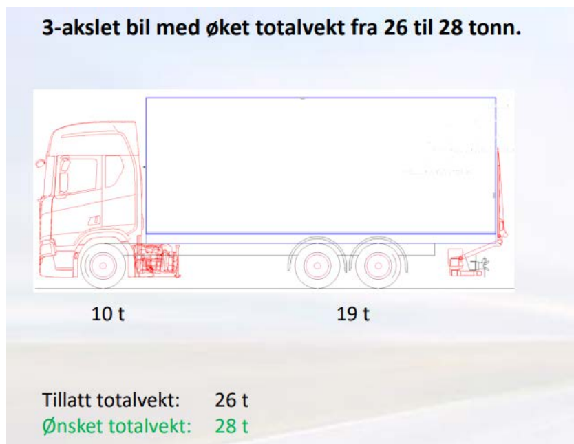
Figur 1.1: Illustrasjon av 3-akslet lastebil med ønsket økning i totalvekt fra 26 til 28 tonn. Kilde: Nordvik, 2022.
