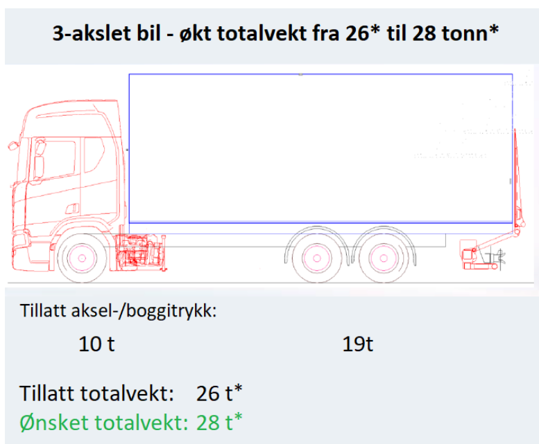
Figur 1.1: Illustrasjon av 3-akslet lastebil med ønsket økning i totalvekt fra 26* til 28* tonn. Opprinnelig basert på Nordvik (2022). * ekskl. en eksisterende dispensasjon som gir inntil 2 tonn tillatt tilleggsvekt for nullutslippskjøretøy, se Transportvirksomhetene (2023, s.2/3).
